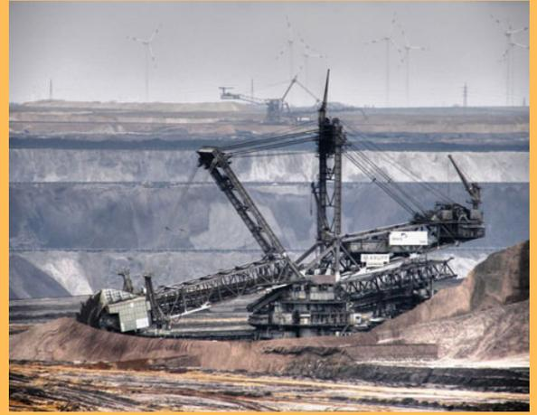
La pelle Bagger 288 : un engin de TP de 13 500 tonnes.
